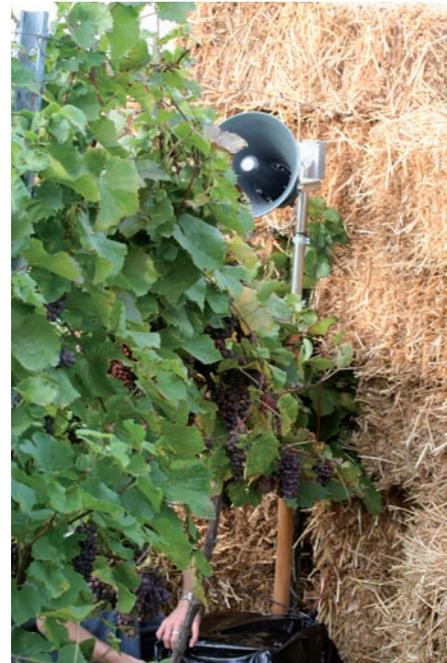
Abb. 4: Für den Einsatz in Siedlungsnähe konstruiertes Phonoakustikgerät mit rückwärtiger Schallschutzwand aus Strohballen
